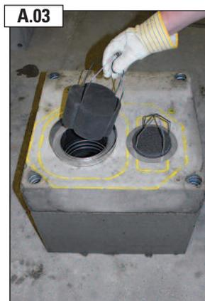
Unteren Schutzschwamm **Abgas** (1) in Montagetrichter einstecken.
