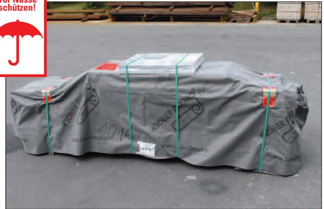
Das KINGFIRE PARAT S-Ofenmodul wird mit einer diffusionsoffenen Feuchteschutzabdeckung angeliefert. Diese Schutzabdeckung darf erst unmittelbar vor dem Versetzvorgang entfernt werden.
