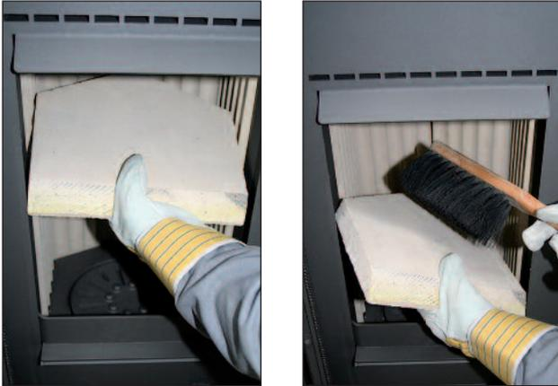
Zum reinigen die Prallplatte vorne anheben bis sie unter den Deckel stößt, das Trageisen vorne entfernen und die Prallplatte vorne in den Brennraum absenken und aus dem Gerät entnehmen. Das Einbauen geschieht in umgekehrter Reihenfolge.
